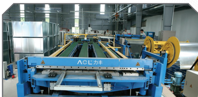
DÂY CHUYỀN SẢN XUẤT ỐNG GIÓ Duct production line
