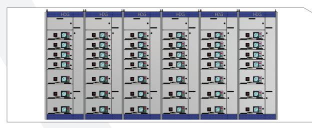
TỦ ĐIỀU KHIỂN TRUNG TÂM MCC MOTOR CONTROL CENTER
